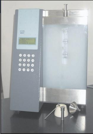
Le Blaine est un appareil utilisé pour déterminer la surface spécifique des ciments et autres produits en poudre.
